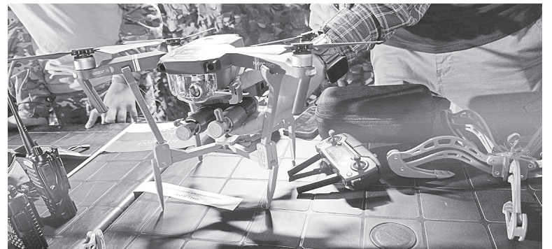
Стартовый столик для беспилотников, напечатанный на 3D-принтере.
