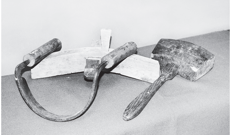
Инструмент бондаря: шкловка, уторник, киянка, начало XX века. / ФОТО из фондов Старочеркасского музея-заповедника
